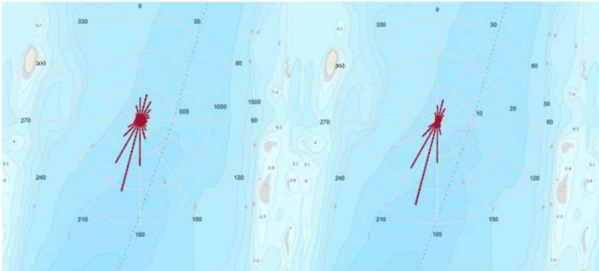
Figur 2.1.2 Strømforhold. Fordelingsdiagrammet til venstre angir antallet målepunkter (frekvens) i ulike himmelretninger. Figur til høyre viser relativ vannfluks som angir hvor stor prosent av vannmassene (mengde) som fordeler seg i de ulike himmelretningene. Målingene er utført på spredningsdypet, 66 m. Kartdatum WGS84 (Åkerblå 2018).
