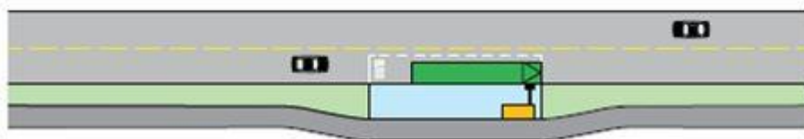
Figur 21 Kantstopp med gang- og sykkelveg
